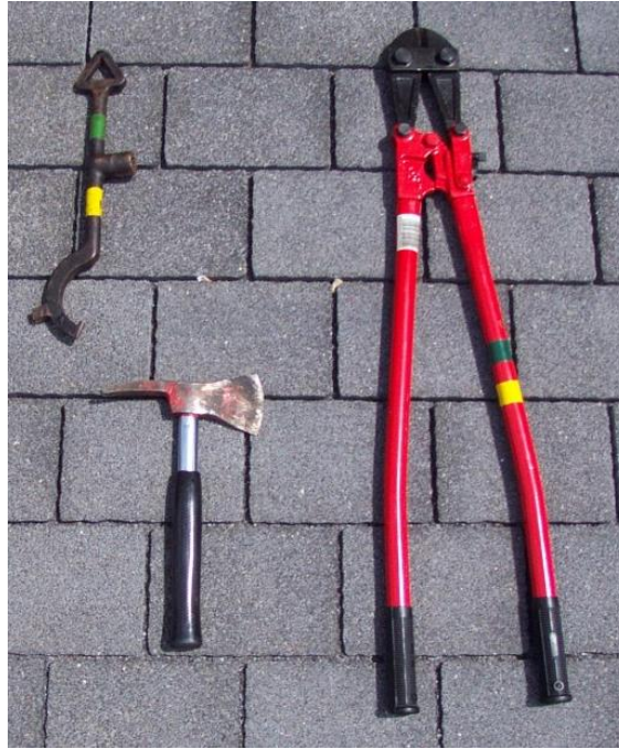
Hydrantenschlüssel, Feuerwehrbeil, Bolzenschneider
